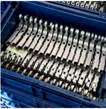
Das sind Schalthebel für das VW-Doppelkupplungsgetriebe, gefertigt aus Zink. | Bild: Hans-Juergen Goetz
