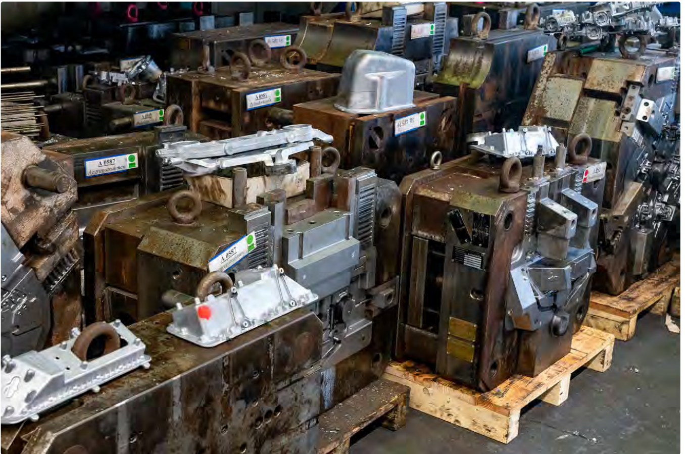
Das sind die Werkzeuge, mit denen das Unternehmen seine Alu- und Zinkprodukte herstellt. Die größten wiegen fünf Tonnen. | Bild: Hans-Juergen Goetz
